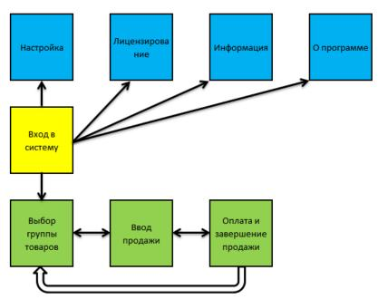
Последовательность и взаимосвязь между экранами призваны обеспечить удобство и максимальную скорость работы.
