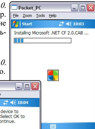
14. После завершения установки мобильное устройство необходимо перезагрузить. Нажмите **OK** и дождитесь окончания перезагрузки.
